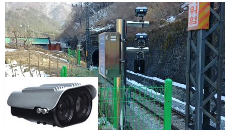
지능형 낙석감시시스템 현장 장비 구성
